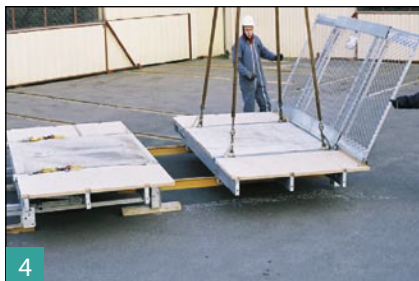
4 Lever et positionner la REMAT sur les coulisses à l'arrière de la PRM.
