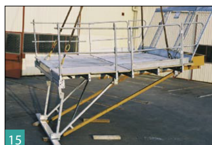
15 Mettre en tension les bracons. La plateforme ainsi équipée de la REMAT est prête à l'emploi.
