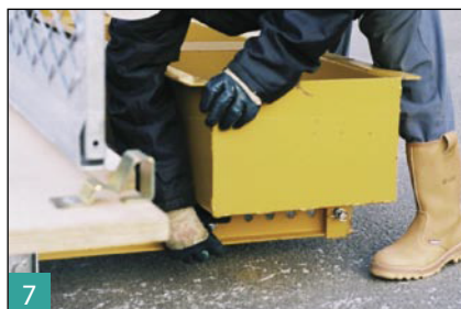
7 Amener le bac lest et le brocher sur les coulisses arrières de la REMAT. Remettre l'auvent en position inclinée.
