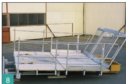
8 Mettre en place les fermetures : une fermeture fixe sur la PRM une fermeture articulée sur la REMAT.
